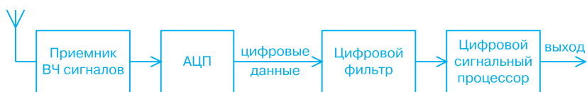
Рис. 5. Структурная схема приемника с цифровой обработкой сигналов в тракте ВЧ
